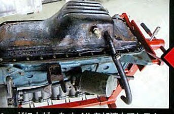
ヘッドに上がったオイルを加速中でもスムーズにオイルパンに戻せるように、ヘッドの後端からオイルパンにリターンホースが伸びる
