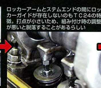
高回転を意識した設計 ロッカーアームとステムエンドの間にロッカーガイドが存在しないのもTC24の特徴。打点が小さいため、組み付け時の調整が悪いと脱落することがあるらしい
