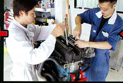
カムカバーを確認 外したカムカバーの裏側は綺麗で、汚れたオイルのまま走らせていた痕跡は無い
