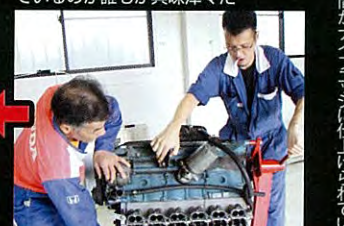
エンジンを裏返す。腰下もOS技研で製作されているはずなので、どうなっているのか誰かが興味津々だ
