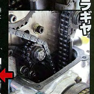
デュアルアイドルギヤ チェーンは両側からアイドルギヤに押さえ込まれ、カムプロケットの歯とチェーンの密着性を上げている。このギヤも他のエンジンからの流用品ではなく、OS技研でTC専用製された物らしいので、新規で入手するのが困難なパーツだ
