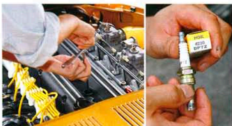
①プラグはNGKのDP7Z(特殊)。ネジ径12mmの二輪用だ。プラグを締め込むにも細心の注意が要る。
