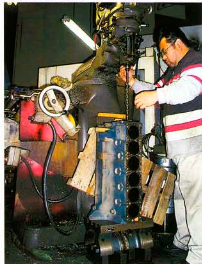
●意外に手こずったオイルパン。このTC24はスカイラインジャパン用L20ET(ターボ)のブロックを使っていたため、オイルパンは前側に油溜まりのある「前ツボ」。一方、TCを載せようとするフェアレディZは逆の「後ろツボ」。Zの後ろツボをスカイラインに流用するのは容易だが、その逆は例がない。というのも、こうしてブロックのオイルラインを20cm通し直さねばならないから。
