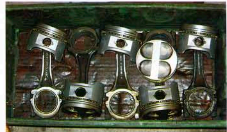
●TC24のピストンは専門メーカーに特注した専用品。だがこれは初期モデルらしく、暫定仕様のLZ用が入っていた。ボア87.8mmだがリングがなかったので現行車用88mmを流用(トップ、セカンド。オイルはLZ用)。
