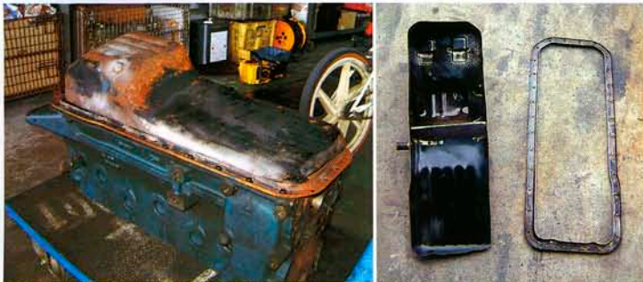
●当然、オイルパン本体も前後逆に移植。糸ノコでフチを切り抜いて、歪みが出ないようブロックに固定し溶接した。完成後は灯油を1週間溜めてテスト。
