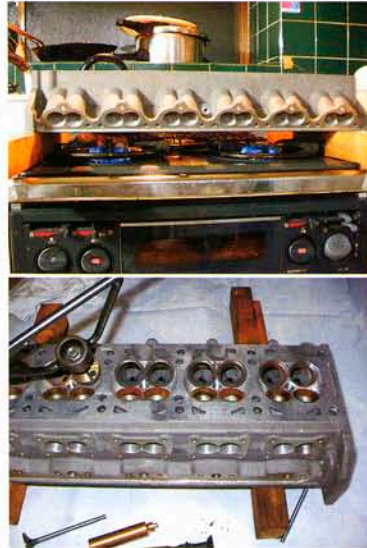
●自宅のガスレンジでヘッドをあぶり、バルブシート、バルブガイドを打ち込む。ガイドを打ち込むこの工具は自作品。
