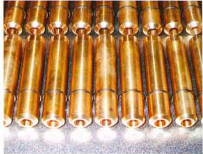
●そこで燐青銅の丸棒から削り出すことに。旋盤で削り、ドリル歯で穴を開け、リーマーを通すという当時と同じ方法で自作。基本サイズは4種類になった。
