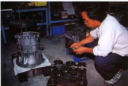
●そのOS技研での上司が、サングラス姿で第1ページに登場していた。内田勝也さんだ。内田さんはOS技研の技術開発担当。富松君は様々な助言を得てきた。前に置いてあるのは内田さんが開発設計したR32～34GT-R用の6速シーケンシャルミッション。1500馬力にも耐える。
