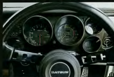
⑩ブリッド製のヒストリックス/バケットシートを装着したインテリアはスバルタンクのもの。写真では見えないが、レース用ワイドミラーは自作だ。⑪インパネ回りは純正を生かし、Defi製のタコメーター、GReddy製の油温、油圧、水温計を埋め込んでいる。ステアリングは定番のダツコンペ。
