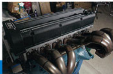
2.4リットルのツインカム4バルブエンジンを搭載するS30Z。そのエンジンは、ニッサンのL型6気筒エンジンブロックにツインカム4バルブヘッドを搭載したTC24-B1。70年代、岡山のOS技研によって開発されたコンプリートエンジンである。現存4〜5基だそう。
