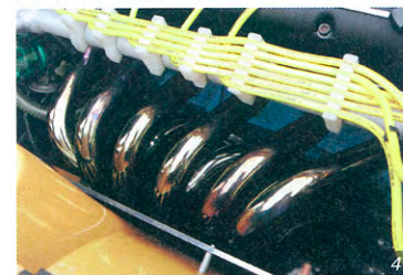
4.美しい輝きを放つステンレス製等長エキマニ。クロスフロー化に伴いキャブは逆バンクへ移動しているため、エキマニの放熱対策が不要で見た目もスッキリ。5.ロールケージとタワーバーで車体剛性を確保。そしてストラットタワーを良く見ると、その形状を利用したスピーカーの姿が。
