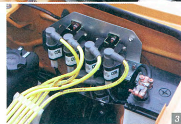
1.徹底的なボディレストアが施されているので、室内は床までクリーン。ロールケージが組まれるが、インテリアは基本的にストックを保つ。2.キャブはウェーバーの50φ。通常のL型なら大きいサイズだが、TC-24とのマッチングは良く全域でパワーが出るという。3.ダイレクトイグニッションで点火系を強化。ヘッドのど真ん中にプラグが刺さるルクスは、DOHCならではの。
