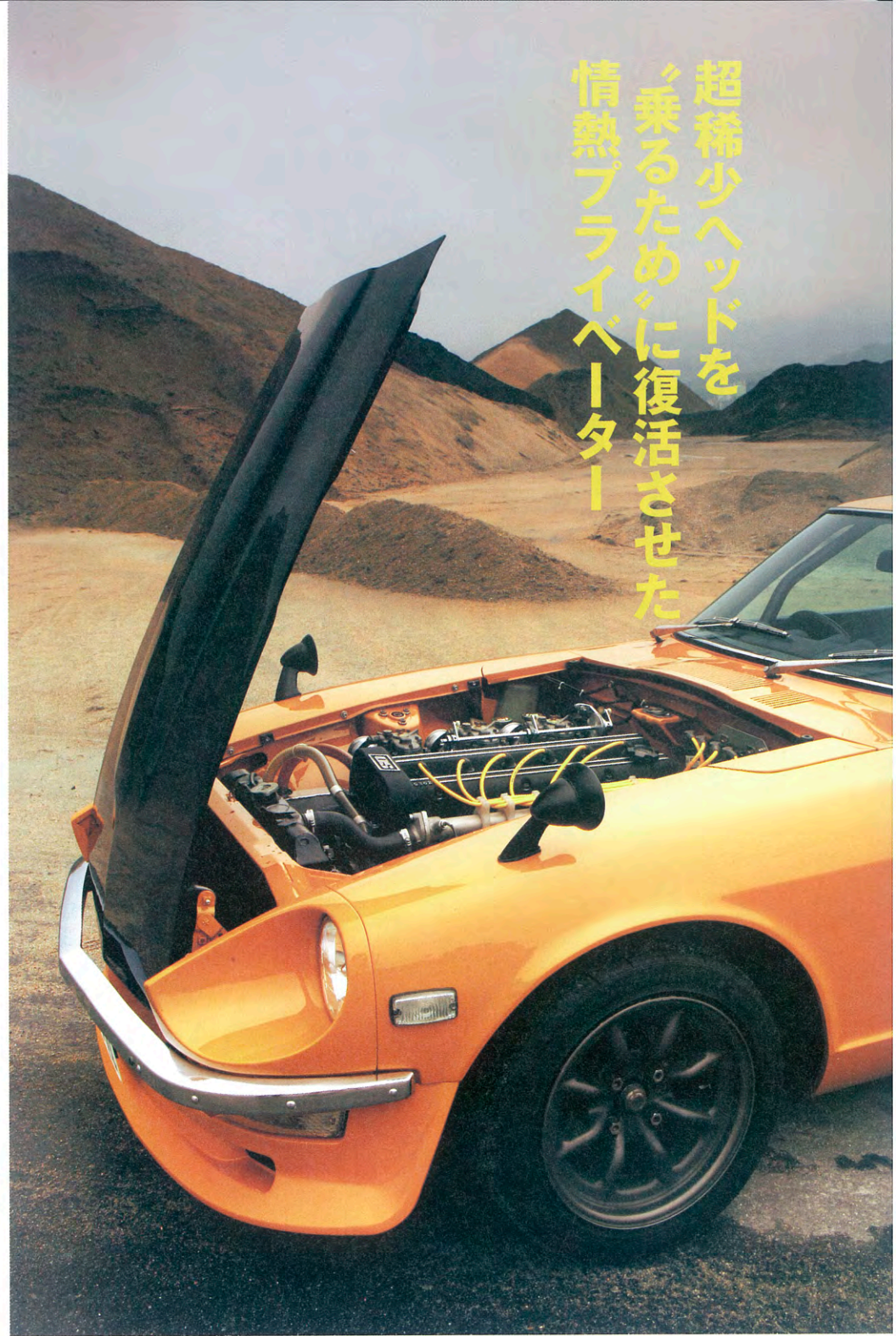
1.徹底的なボディレストアが施されているので、室内は床までクリーン。ロールケージが組まれるが、インテリアは基本的にストックを保つ。2.キャブはウェーバーの50φ。通常のL型なら大きいサイズだが、TC-24とのマッチングは良く全域でパワーが出るという。3.ダイレクトイグニッションで点火系を強化。ヘッドのど真ん中にプラグが刺さるルクスは、DOHCならではの。
