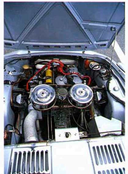
初代パブリカと同じ空冷水平対向2気筒の2U型エンジン。820ccまでポアアップされ、ハイコンプ・ピストンとハイカムが組まれている。注目目はキャブレターで、なんとダンドラのシングルバレルを3連装！メッキされたエアクリナーがイカしてる。
