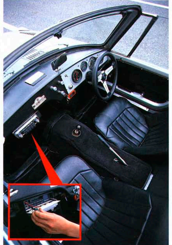
レブカウンターを社外品に交換、ダッシュパネル中央に3つ並んだスイッチのノブは、これまた富松さんがアルミを削り出してつくったモノ。で、いちばん感心したのがオーディオで、当時の純正AMラジオしか見えないけど、じつは左のスイッチノブを抜くとパネルが開いて(AMラジオはダメーなのだ!)カセットチューナーが現われるって寸法。旧車の雰囲気壊したくないというオーナーのこだわりだ。
