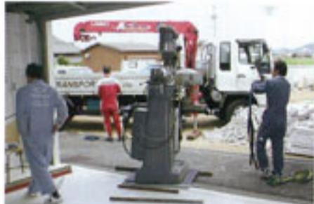
●続いてやってきた英国ブリッジポート製フライス盤。φ12mmの丸棒を1m30cmほどに切ってコロとし(10本)、その上に12mm鉄板を敷いて機械を乗せ、ウインチで引いた。設置時はコンクリの上にスポンジとこの鉄板を敷いた。
