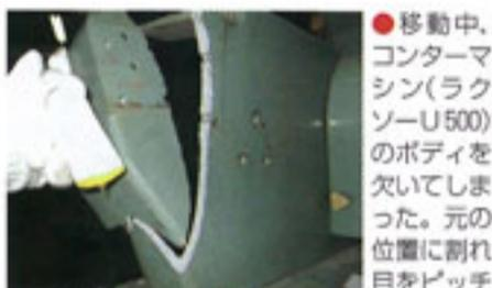
●移動中、コンターマシン(ラクソーU500)のボディを欠いてしまった。元の位置に割れ目をピッタリあわせて溶接。真ん中から割れていたネジタップも締め付けられた。
