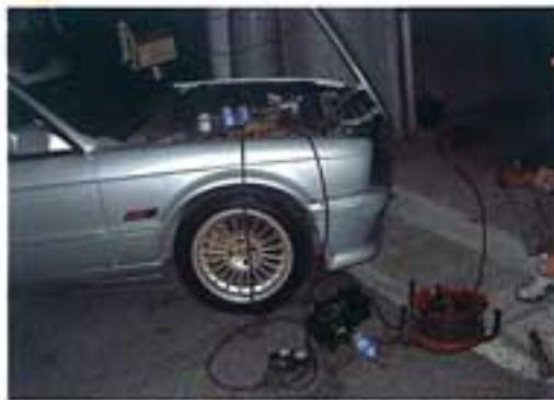
これはいわば初步編。機能不全に陥ったボッシュ製斜板式コンプレッサー(手前)をデンソーの軽自動車用に交換。これだけコンプレッサーの大きさが違うが、純正品の小加工でプラケットが自作できる。
