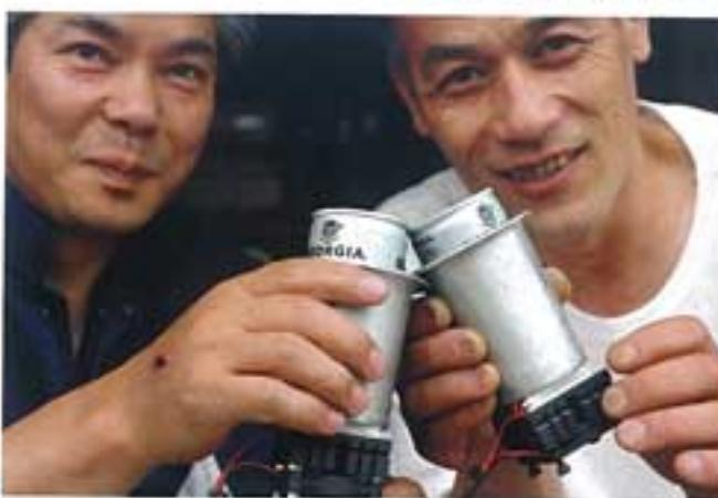
●この怪しいオヤジたちの関係を今、追求するのは避けよう。とにかく新機軸のカップホルダーで乾杯している。炎天下にもかかわらず缶コーヒーはキンキンなのだ。タネを明かせばファンネルの底に取り付けた「ペリチエ素子」(白いパッド状の物)。冷却効果のある電子部品の一つで、2種類の金属の接合部に電流を流すと片方の金属からもう片方へ熱が移動するという「ペリチエ効果」を利用した素子。可動部が無く、騒音を発生しないのでコンピュータCPUの冷却装置、ミニ冷蔵庫に使われている。
