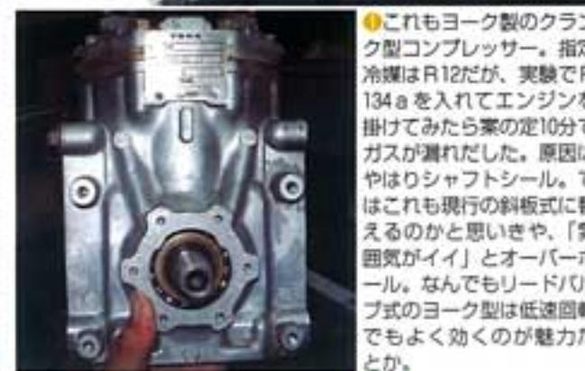
これもヨーク製のクランク型コンプレッサー。指定冷媒はR12だが、実験でR134aを入れてエンジンを掛けた結果ガスが漏れてしまった。原因はやはりシャフトシール。ではこれも現行の斜板式に替えるのかと思いきや、「露圧気がイイ」とオーバーホール。なんでもリードバルブ式のヨーク型は低速回転でもよく効くのが魅力だとか。
