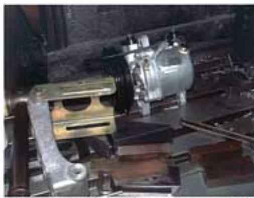
見切れているが左が純正のプラケット。アルミ製のベースに長穴の開いたステーが付く。問題はいかにして幅広のプラケット取り付け穴を流用コンプレッサーに合わせるか。ベースはアルミ製物だから溶接もそう簡単ではない。
