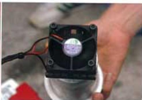
●ペリチエ素子の反対側は、移動した熱で触れられないほど熱くなる。そのため引っ張りの冷却ファンを付けてみたが、このままクルマで使えば車内温度は逆に上がってしまう。うまく排熱だけを車外に逃がすよう
