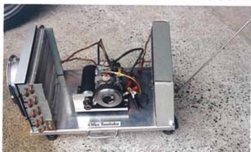
●「ひえ研」が現在、莫大な資金を投じて開発中なのが、この「電動可搬式自動車用クーラー」(お散歩ダッキータイプ)。可搬式と言いつつも荷物ムキ出しで運びにくいので、牽引フックと専用牽引棒を装備した。左側がコンデンサー、右がエバボレーター(ともにパソコン用冷却ファンを引っ張り方向で使用)。コンプレッサーはデンソーの軽自動車用で、それをスクラップヤードで調達した12Vモーター(用途不明)で駆動する。ベルトはバンドーのコクドタイプ。ブーリー比は1:4で歯飛び防止のペアリング入りテンショナーが付く。台ならびにケーシングは主任研究員・ヘンカタ氏の板金による。
