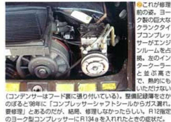
(コンデンサーはフード裏に張り付いている)。整備記録簿をさかのぼると98年に「コンプレッサーシャフトシールからガス漏れ要修理」とあるのだが、結局、修理しなかったらしい。R12指定のヨーク型コンプレッサーにR134aを入れられたときの症状だ。
