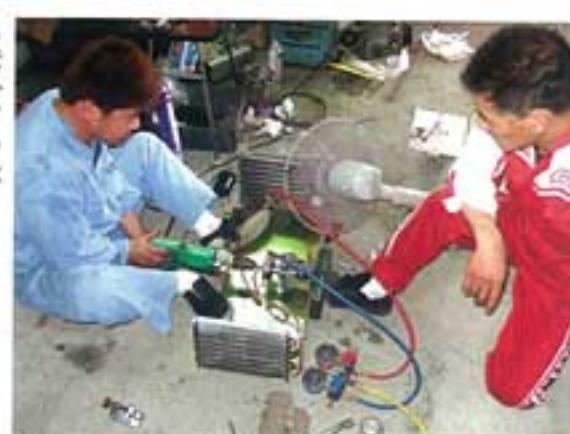
●そして完成した可搬式クーラー。さっそく電源を入れてみる。12Vバッテリーでもコンプレッサーはなんとか回り、外気温度差10℃程度の涼風が流れ出た。
