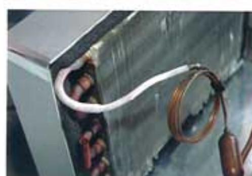
●エバボの銅管にはうっすらと霜が。ちなみにミニクーラーにはエキスパンションバルブではなく、高圧ガスの開放・霜化は先端が絞られた渦巻き状の部品「キャビラリーチューブ」で行う。電動式コンプレッサーは回転が一定だから、エキバンのような制御弁が必要ない。キャビラリーチューブの巻き数によって冷凍特性も変わるが、これは今後の研究課題。またエバボ、コンデンサーのケーシングも冷却効率を大きく左右する。空気が流れやすい形状であることは当然だが、ケースとユニットの透け間をスポンジなどでしっかりと目張りして、熱交換損失を防ぐことが大事。今後は配線抵抗、熱交換損失、ブーリー比などを見直し、連続使用3時間(車載)、外気温度差15℃を目標とする。
