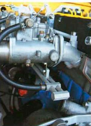
●ブレーキブースター用のバキュームラインを3力所から取っている。ハイカムゆえ吹き返しが多く、1力所では力不足。パイピングはアルミパイプ+ナット+ロウ。キャップスクリューにはしっかり通気孔が通る。
