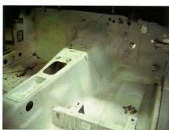
⑩ドア後端クオーターパネルは0.3mmステン板+1mm鉄板+リベットでサンドイッチ補修してあったがグサグサ。すべて剥がして切り張り。
