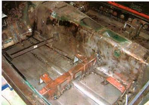
④フロアにもステンの薄板が張ってありボロボロ。全面を切除してオリジナル同様リブを打った鉄板で張り替えた。フロアメンバーも製作、同時に補強を施している。
