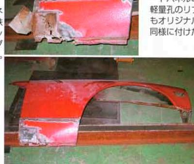
⑪防錆剤→バテ→サフの順で仕上げていく。使った塗材はハイブライマー、イージーバテ、ジンクプラサフ（いずれもロック製品）。
