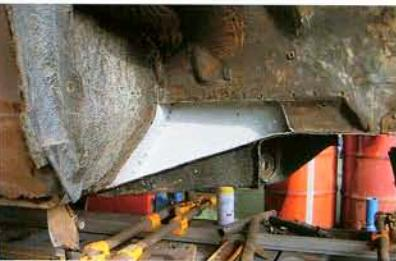
⑨完成したフレーム補強。左のRがサイドシル、右がフロントサイドメンバー根元、手前が進行方向。最後に防錆剤を充填。
