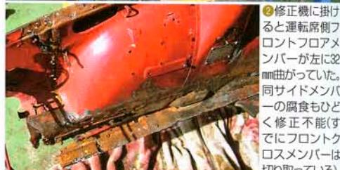
②修正機に掛けると運転席側フロントフロアメンバーが左に32mm曲がっていた。同サイドメンバーの腐食もひどく修正不能（すでにフロントクロスメンバーは切り取っている）。
