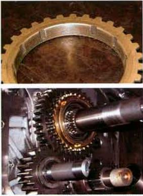
②しかもS14用にはバックシンクロが付く。Lのエクステンションケースを使うと走行中でも5速からリバースに入ってしまう危険性がある(S14用はリンクージに飛び込み防止機構がある)。そこでバックシンクロを殺すことに(写真の輪っかがテーパー穴を削ったシンクロナイザーリング)。カウンターシャフトペアリングはL用を使用。
