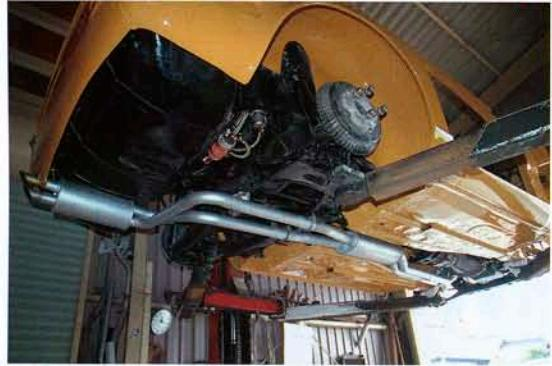
● フューエル、デリバリパイプもアルミニウムとナットを口ウ付けした。鋳鉄のような風合いは珪砂をプラスしたため。リターンも付く。
