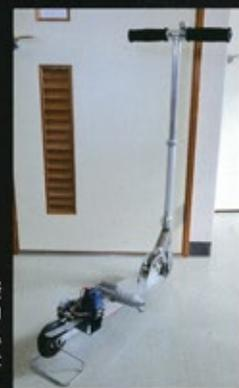
キックボードの改造に凝った時期があり、ラジコン用のエンジンを組み込んだ力作。エンジンで走行できるスグレモノだ。
