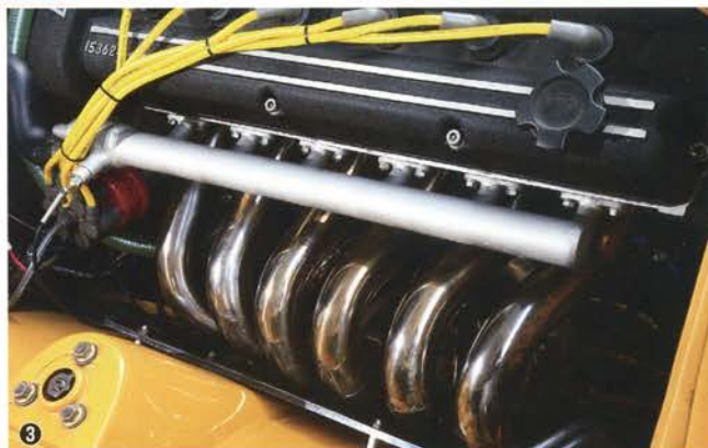
③美しさが際立っているタコ足は、長瀬発動機が製作を手がけた。パイプ径はφ50mmに設定し、集合部までは79cm。ボディ側には遮熱板も装着している。
