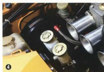
④マスターバックはHA22Sアルトからの流用。「利きすぎて困るぐらいに良く利きますよ」と富松さん。⑤ボンネットダンパーは、ボルシェ930ターボのリアゲート用ダンパーを流用している。⑥ボンネットの裏側には、「長瀬発動機」、「寺元」の文字のほか、BREを設立したレーシングカーデザイナーのピーター・ブロックさんのサインが、さらにその隣には、S30Zのスタイリングを担当した松尾良彦さんのサインまで残されていた。ちゃんと誰のサインか分かるように説明まで貼ってあるのが◎
